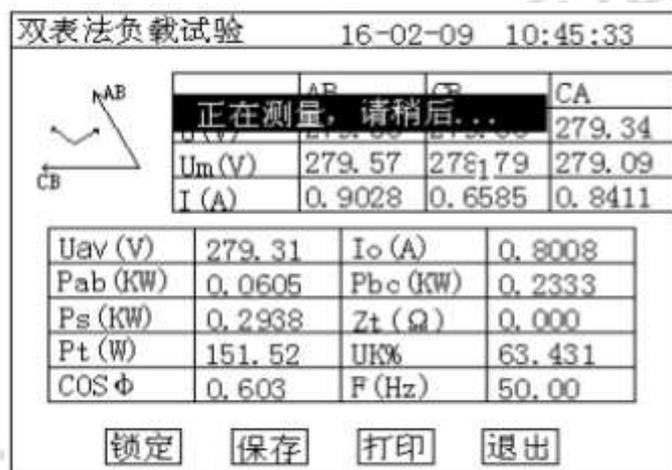
图 12 负载损耗正在测量计算页面
