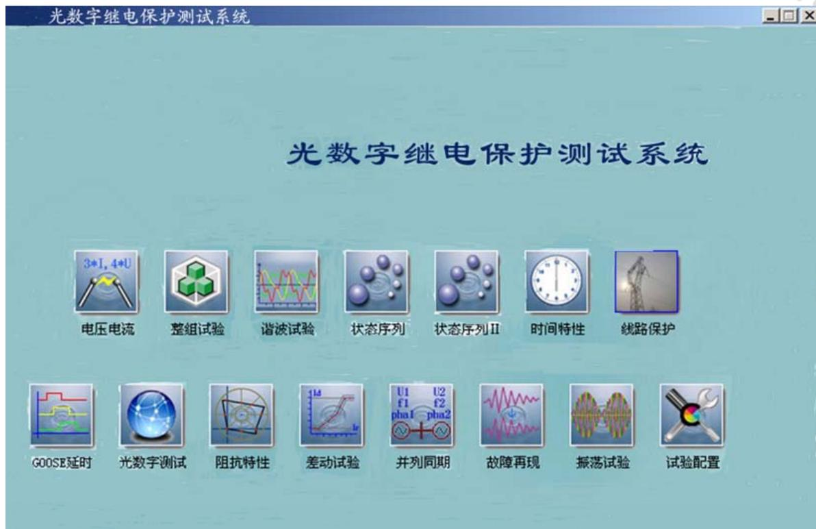
图 0.1 ZH-605D 继电保护测试仪主菜单界面
