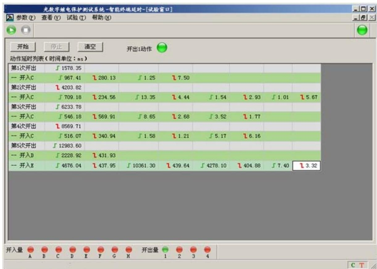
试验过程时，点击开始按钮，再手动点击“开出 1 动作”后面的图标，装置即发出开出信号，装置收到开入动作时，会在下方显示动作时间。
