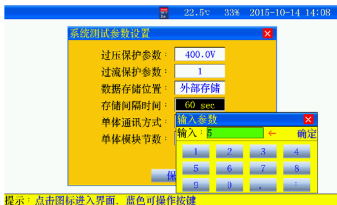
图 3.12 数据存储时间设置界面
