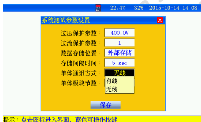
图 3.11 主机与单体模块通讯方式设置界面
