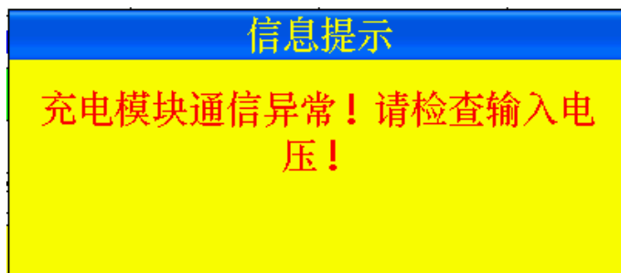
图 3.2.2-1 确定后提示，充电模块异常界面
