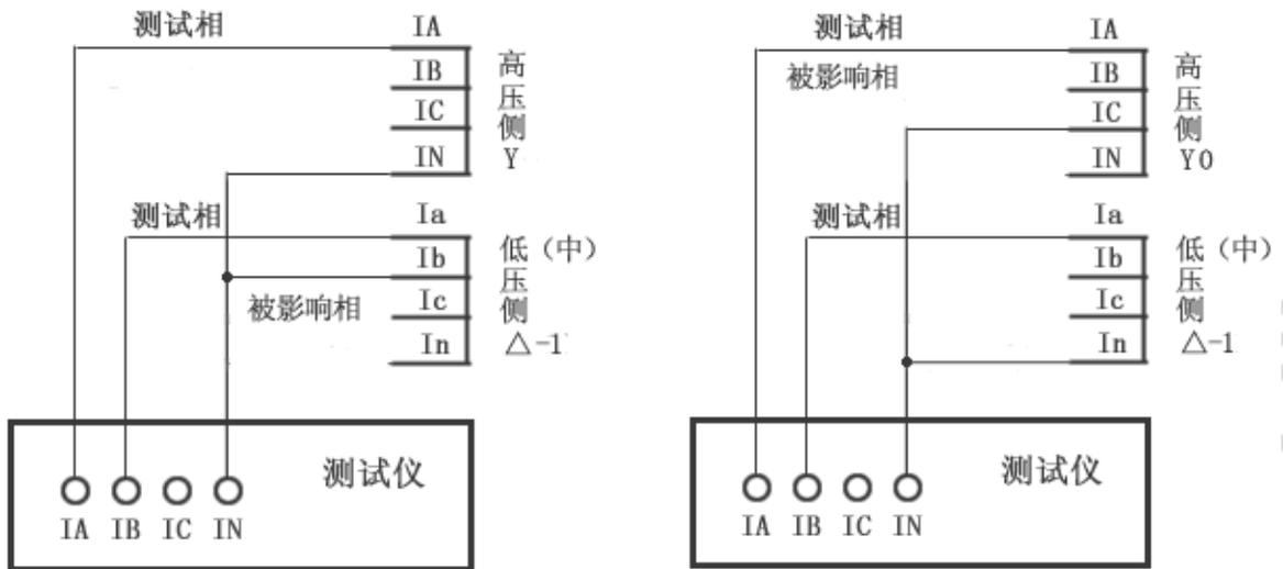
(3). 谐波制动接线——六相电流接线
