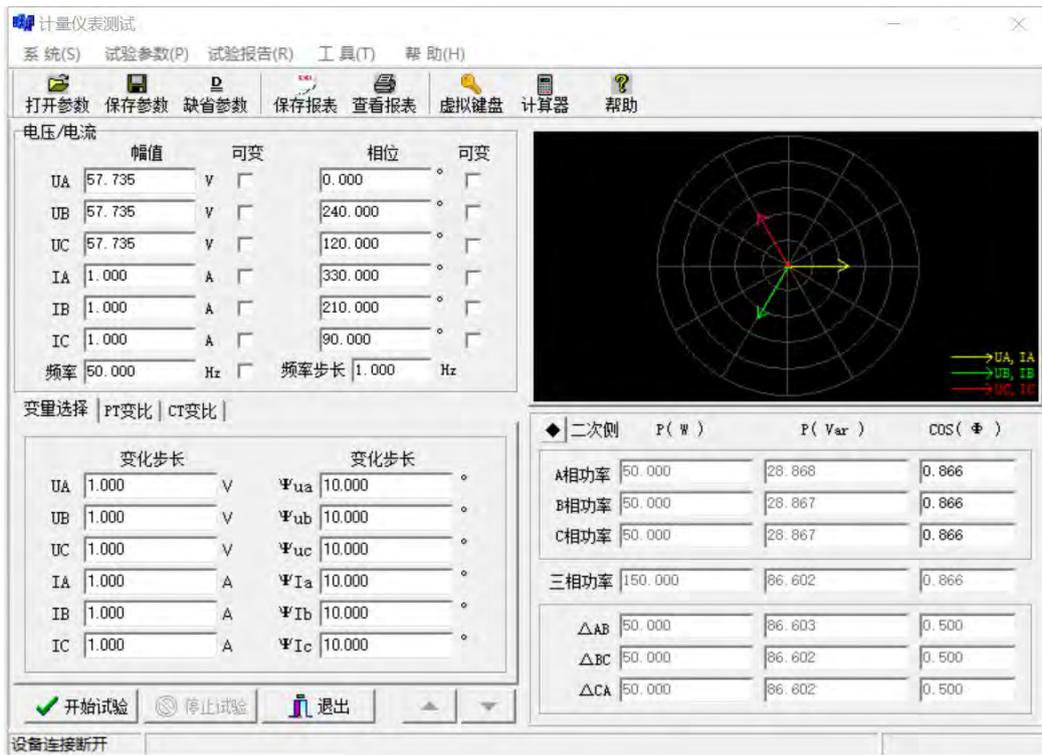
本程序用于检测单相或三相电能表的有功、无功及功率因数。将电流参数和电压参数分别添加到表中相应的栏目，然后点击【开始试验】，将所测得表的读数与界面显示的数据进行对比，测试是否一致。
