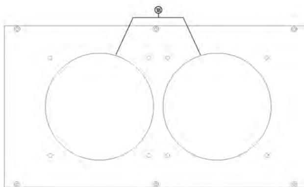
18. 风扇：散热排风扇。（使用时请勿遮挡）
