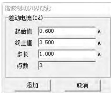
点击“添加序列”按钮，弹出对话框：此对话框用来选择一组差动电流，有起始值和终止值，【起始值】为差动门槛值，【终止值】为差动速断值。步
