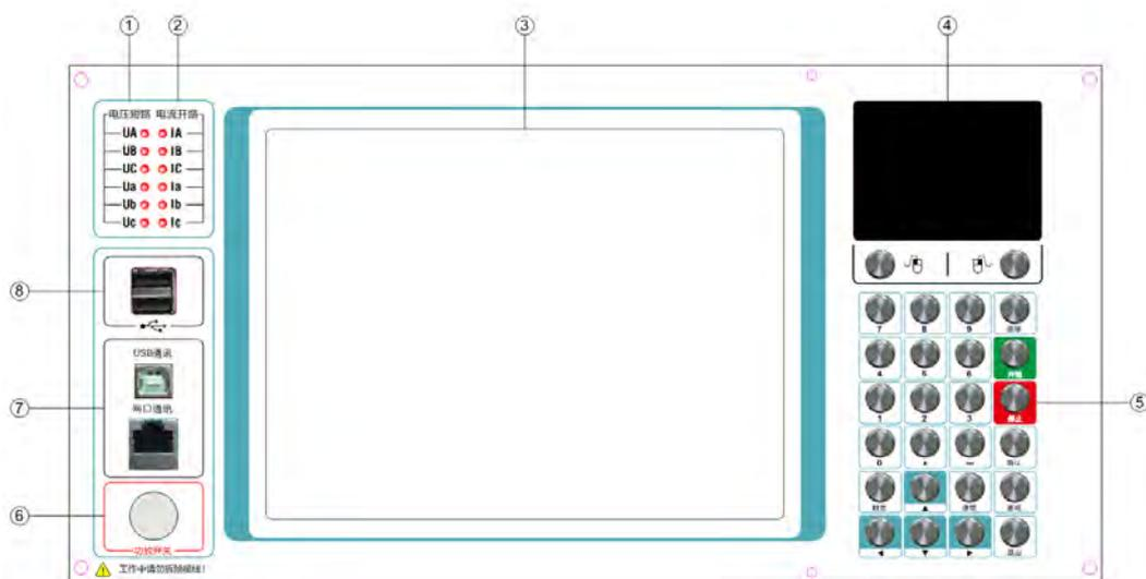
1. 电压短路：LED 亮表示电压源短路示。
