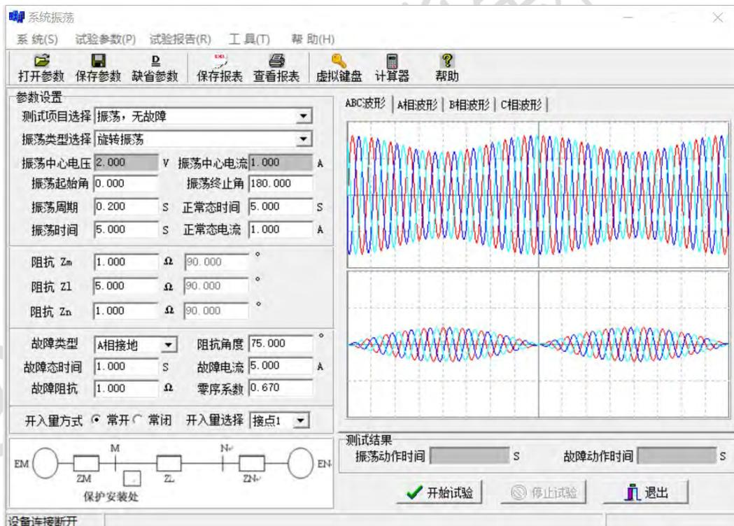
本程序可模拟单机无穷大系统的振荡过程，并可在振荡中加入故障，以测试保护装置能否正确动作。用户输入【振荡周期】一般为 0.2s，【振荡持续时
