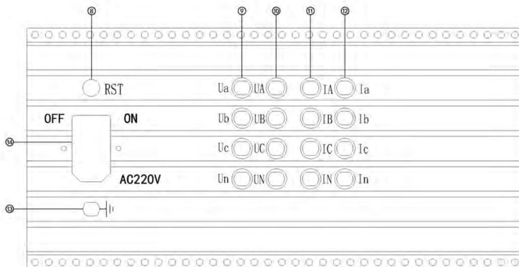
8. RST: DSP 控制板复位按钮，当软件显示发送数据失败或无设备连接时，按此按钮，
