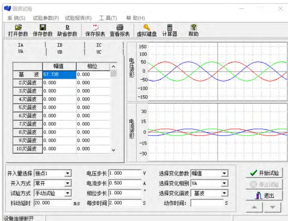
本程序输出三相电流和三相电压，每相电流和电压可在基波上叠加 2—20 次谐波，各次谐波的幅值和相位可任意改变，可以用来测试反映谐波成分的各种装置。
