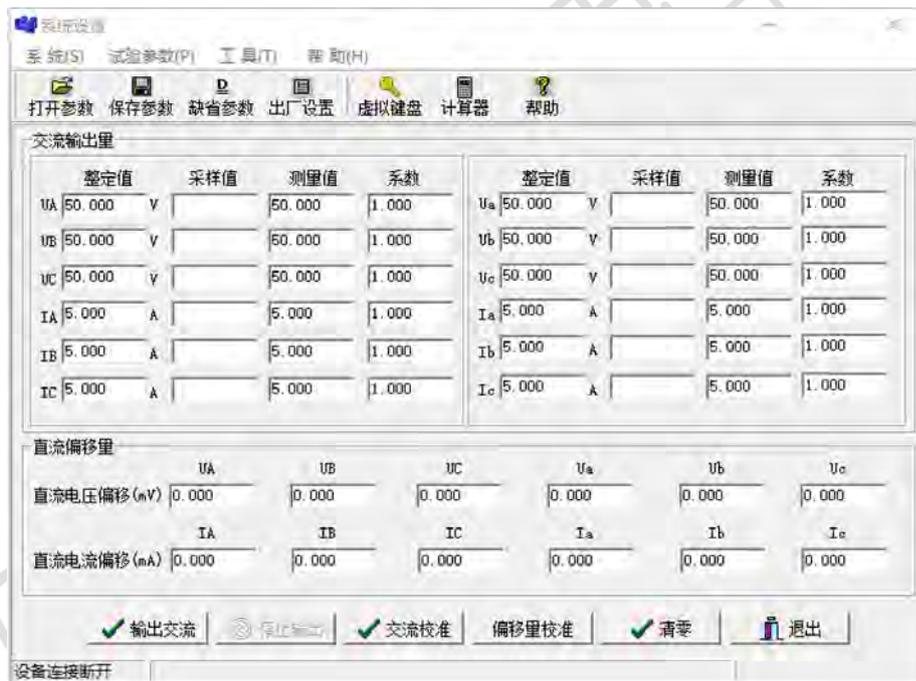
本模块用于装置的精度和直流偏移的校准。本仪器的精度和直流偏移是采用软件自动进行校准，而不是采用传统的电位器调整模式，采用软件校准的优点是精度高，使用方便。使用方法如下：
